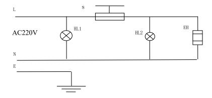
S—TEMPERATURE CONTROLLER S1—TEMPERATURE LIMITER
